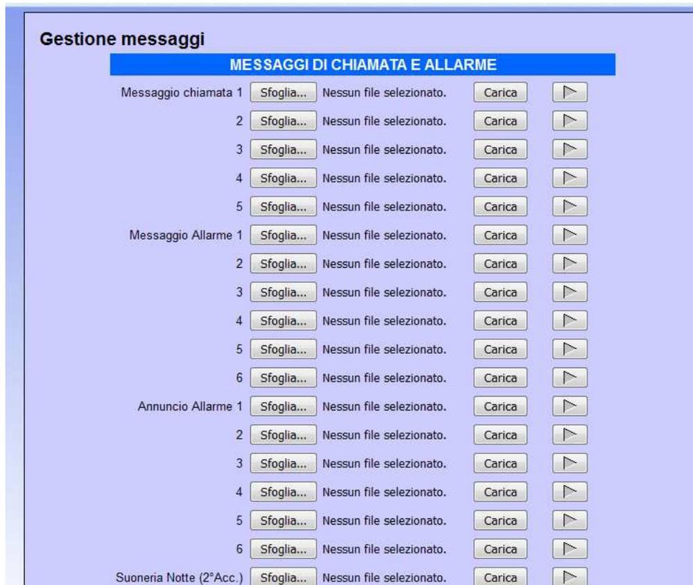
I “messaggi chiamata” da 1 a 5 possono essere riprodotti al momento della pressione di uno dei pulsanti del sistema. L’attivazione e disattivazione del messaggio avviene in remoto, direttamente da un telefono interno. Si possono inserire fino a 5 messaggi da abbinare poi ai tasti premuti. Un esempio di utilizzo di questa funzione è quello di poter dare dei messaggi di istruzione preregistrati in base al tasto premuto dal chiamante/visitatore.
