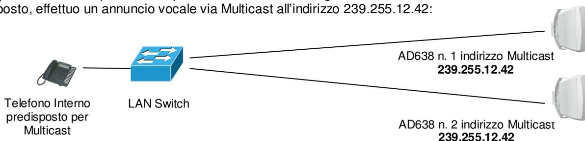
Entrambi i sistemi riprodurranno il messaggio audio di annuncio. Possono essere collegati molti più dispositivi di quelli indicati nell'esempio, non essendoci un limite.
